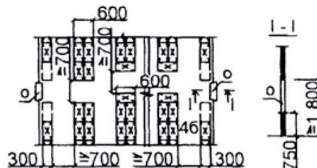
Схема 2. При хранении домашней одежды на переносных каркасах, подвешенных к перекладине
