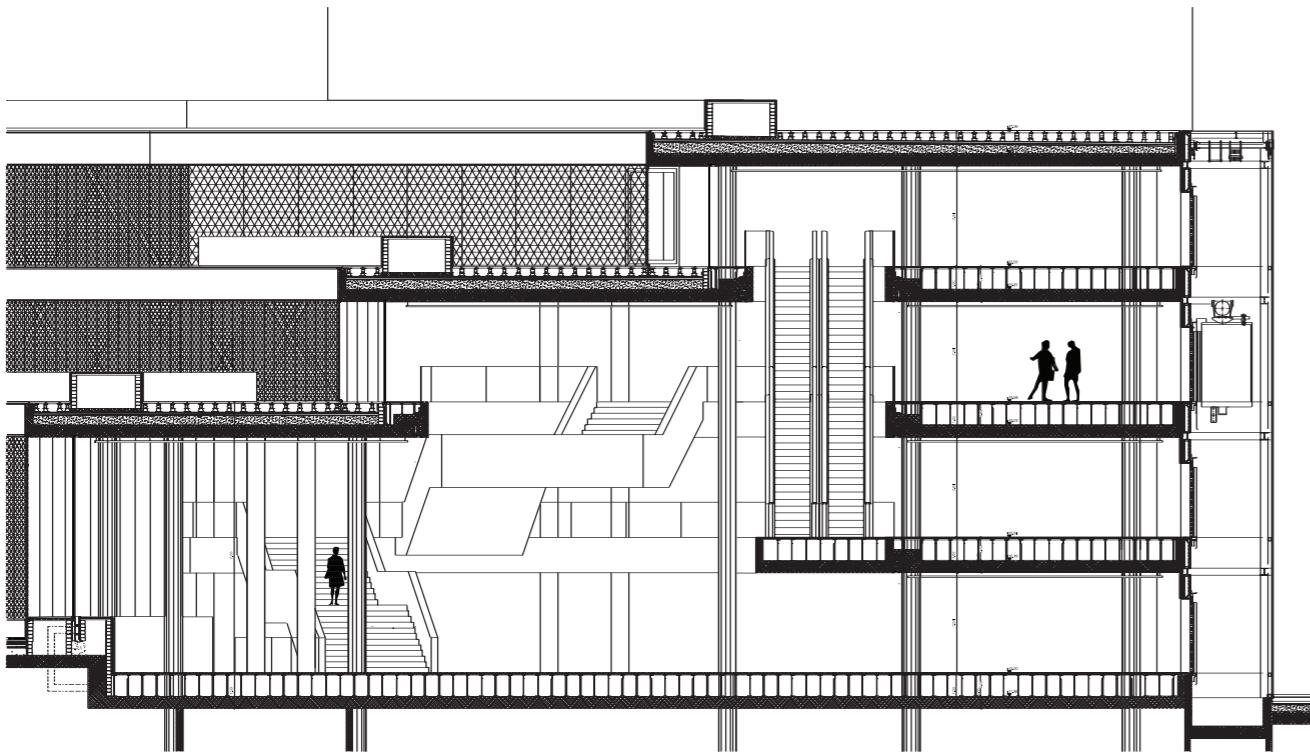
Detalle de sección por Atrio / Detail of section through Atrium
